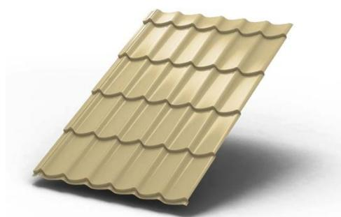
Металлочерепица Макси — металлочерепица, объединяющая в себе классические формы и современный взгляд на дизайн данного кровельного материала. Отличительными чертами данной металлочерепицы является более продолжительный шаг волны, который составляет 400 мм и высота профиля в 21 мм, что в совокупности создает интересный эстетический эффект.
